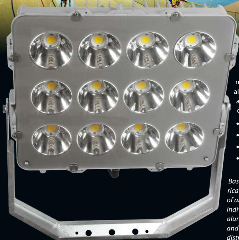
Basata sul principio della riflessione, l'OTTICA PLUS con fascio simmetrico offre la più alta efficienza luminosa per l'illuminazione di impianti sportivi amatoriali e di sport minori professionali. Ogni singolo LED viene avvolto dal suo singolo riflettore, in alluminio ad altissima purezza (99,99%) o metallizzato sottovuoto ad elevata durabilità ed efficienza, per un miglior controllo dell'abbagliamento (UGR e GR) e della distribuzione della luce.
